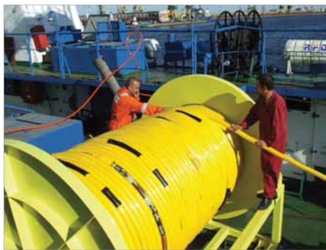
Foto 10 – Infășurarea cablului seismic pe troliu
