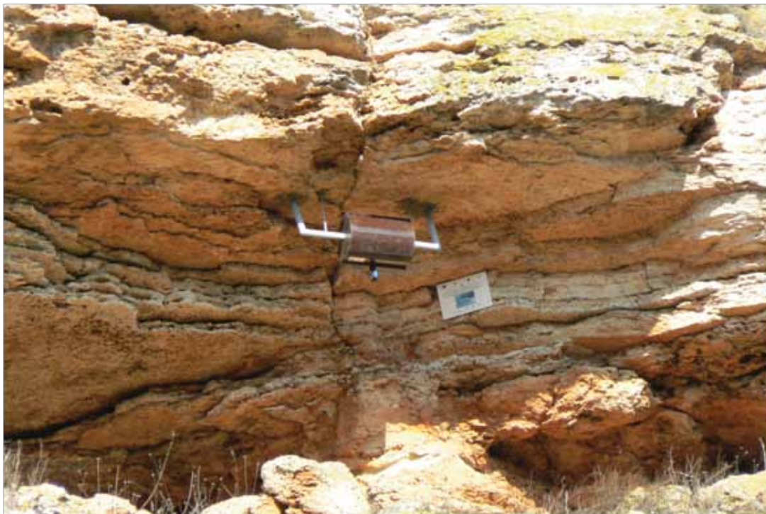
Foto 6 – Localizare extensometru - Cap Kaliakra, Bulgaria
